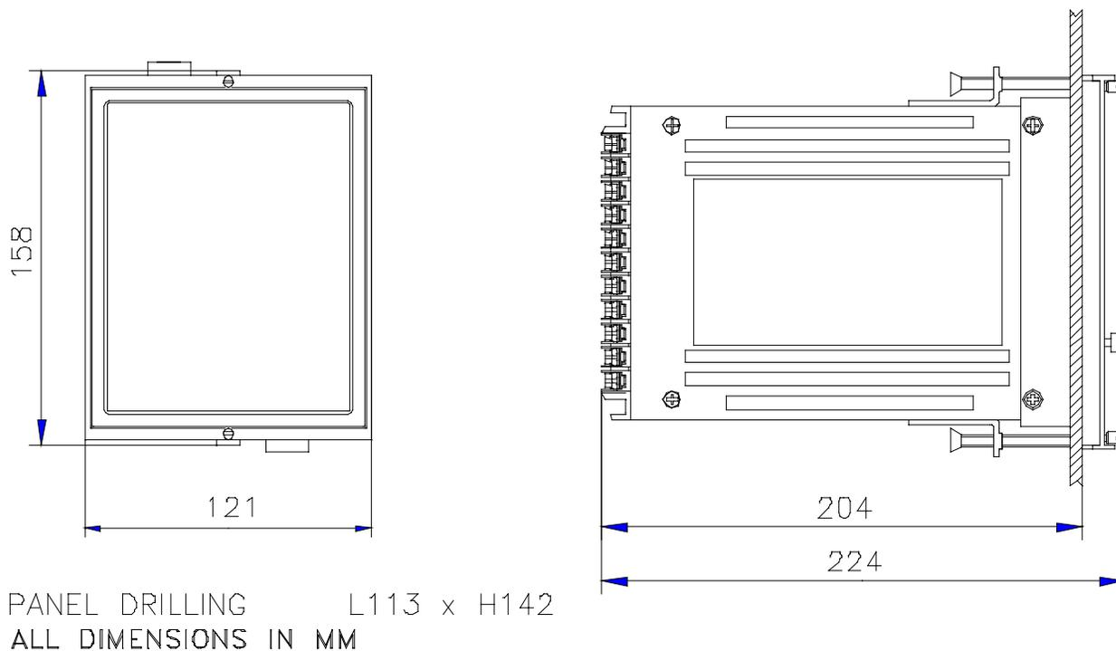
**Figure 1 : SINGLE MODULE ENCLOSURE MOUNTING**
